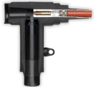
**R-800.** Diseño único patentado que combina en un solo molde un cuerpo en "T" con una derivación en 200A (15KV o 25KV). A diferencia de las pobres copias de otros fabricantes, el R-800 y sus partes internas críticas están totalmente ensambladas en planta, evitando errores por contaminación y ensamble en campo.
